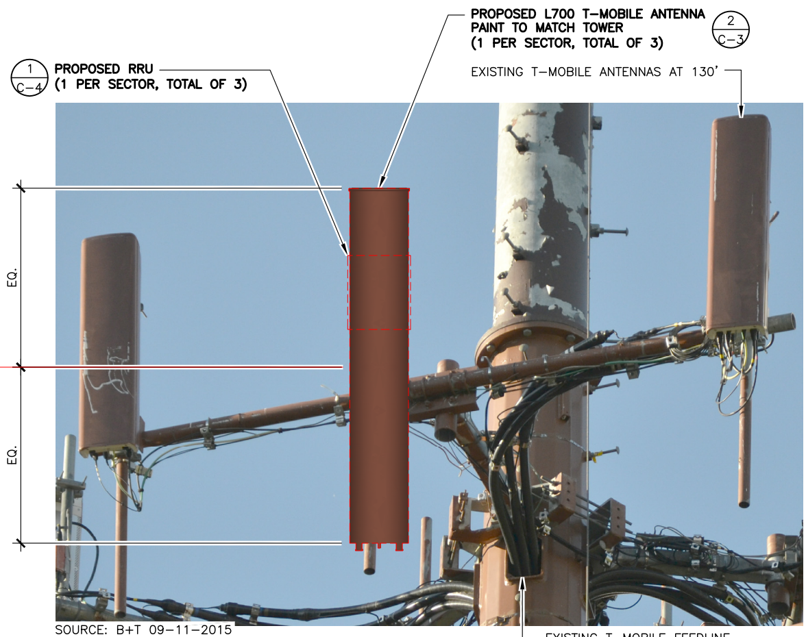
2 ANTENNA MOUNT PHOTO DETAIL SCALE: N.T.S.
