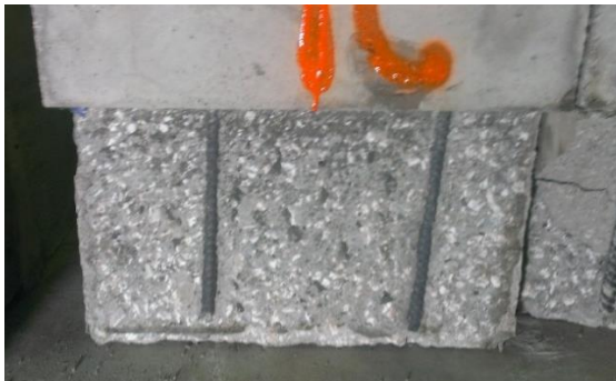
b) Bond interface (substrate concrete)
