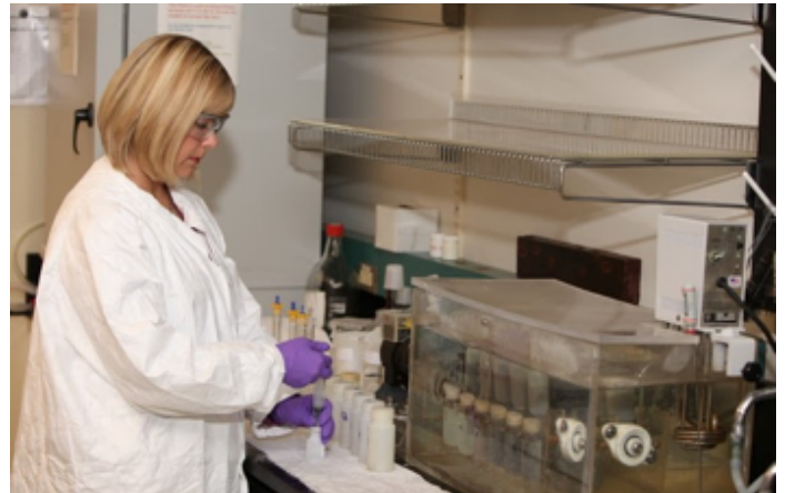
Karen Bradham, investigadora de la EPA, utiliza un “estómago virtual” que imita la digestión humana para determinar si el plomo y el arsénico en la tierra contaminada están biodisponibles.
