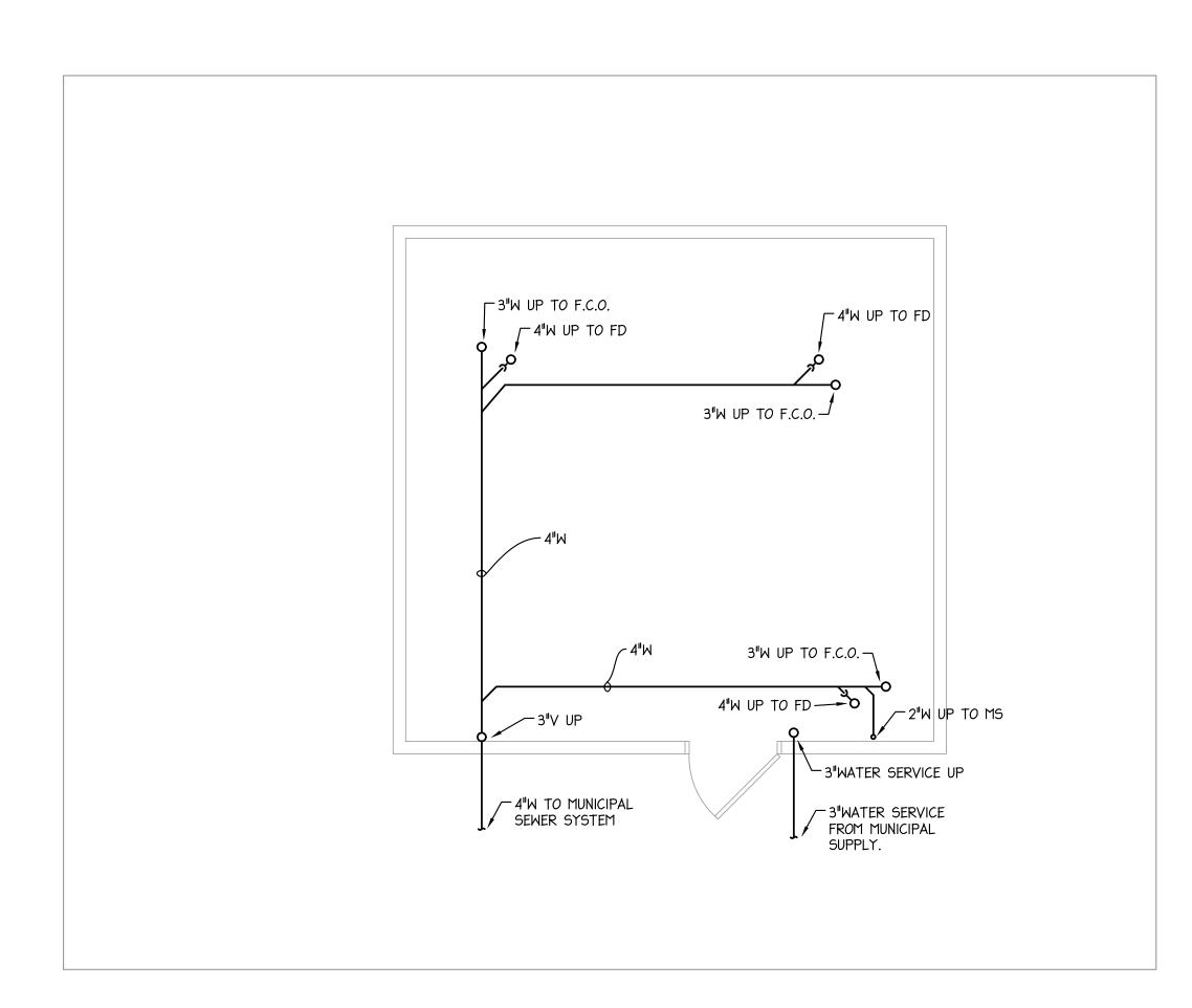
4 PUMP HOUSE UNDERSLAB PLUMBING NEW WORK PLAN
