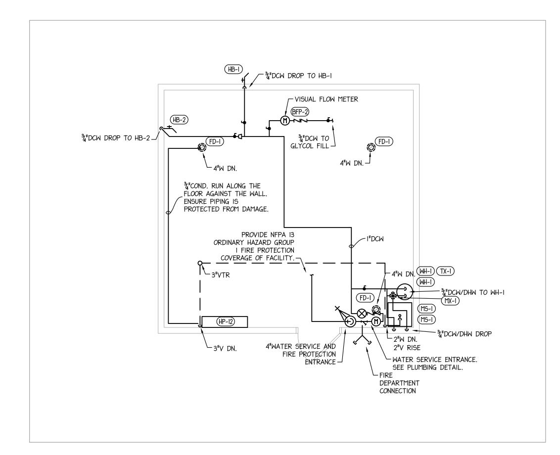
3 PUMP HOUSE FIRST FLOOR PLUMBING & FIRE PROTECTION NEW WORK PLAN
