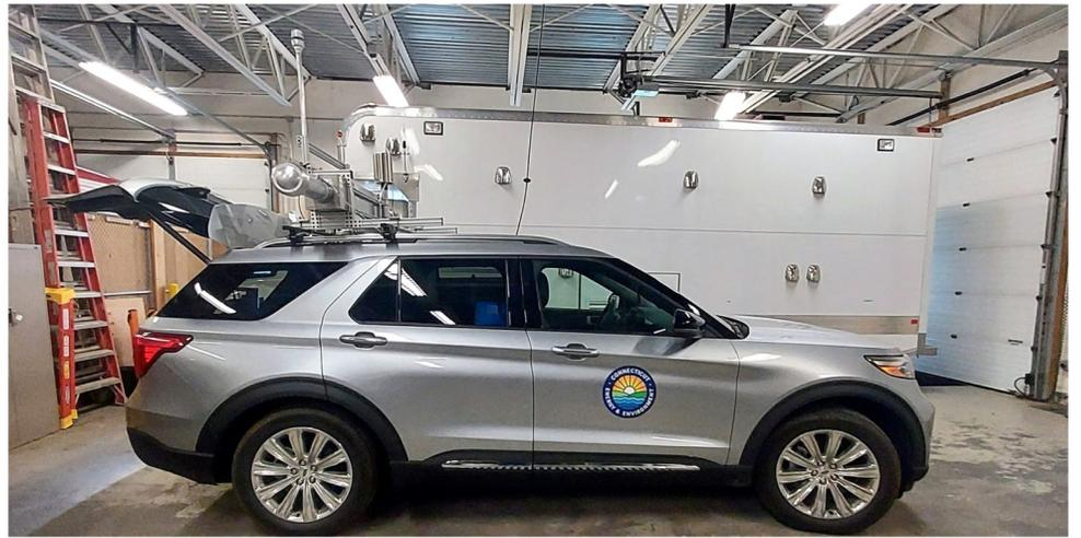
GMAP significa medición geoespacial de la contaminación del aire. GMAP es un acrónimo cuyas siglas significan “Geospatial Measurement of Air Pollution”. El vehículo GMAP de Connecticut está equipado con una variedad de instrumentos que se pueden utilizar para la medición geoespacial de la contaminación del aire.
