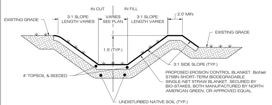
1. SEED MIX TO BE NEW ENGLAND EROSION CONTROL/ RESTORATION MIX FOR MOIST SITES ON THE BOTTOM OF THE BASIN AND NEW ENGLAND EROSION/RESTORATION MIX FOR DRY SITES ON THE SIDE SLOPES.
