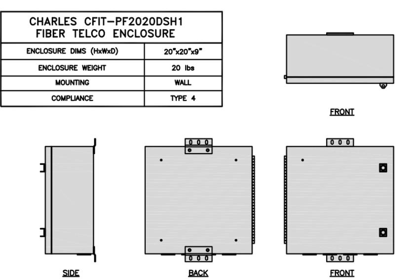
**FIBER TELCO ENCLOSURE DETAIL**      NO SCALE      6
