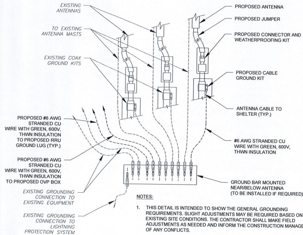
4 TYPICAL ANTENNA GROUNDING DIAGRAM
