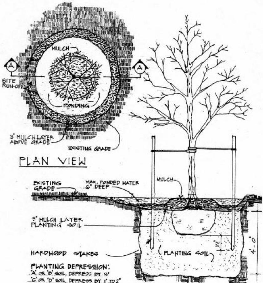
Figure 2.10. Tree pit bioretention
