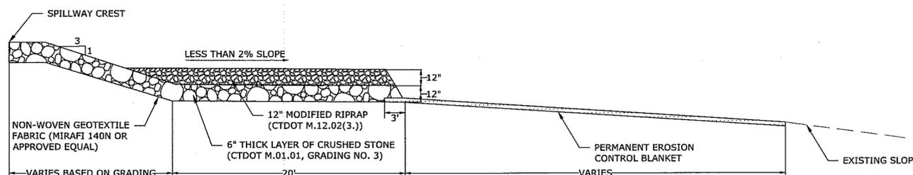
**EMERGENCY SPILLWAY LEVEL SPREADER**
